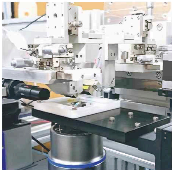
神戸大は樹脂素材を混ぜ合わせる3Dプリンターの試作機を開発を進めている
